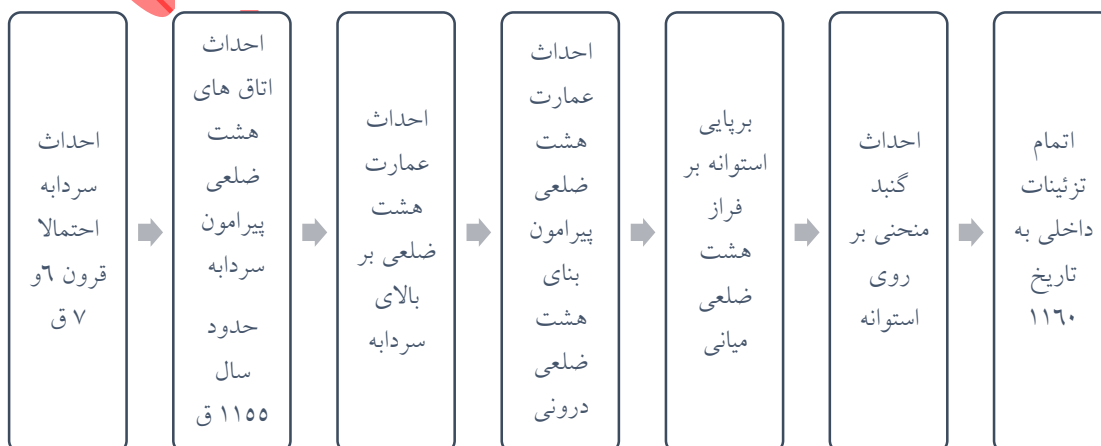
تصویر ۱۷. مراحل احداث عمارت خورشید
