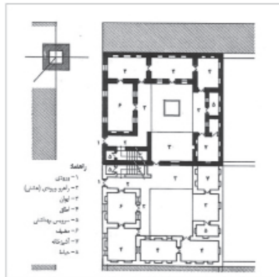
تصویر ۵- نمونه خانه فامیلی بافت قدیم، طبقه اول. مأخذ: (Ghaemian)، تصحیح و تدقیق نقشه در سال ۱۳۶۶ توسط نگارنده
