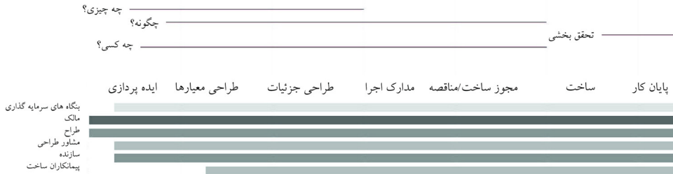
نمودار ۱- مقایسه فرآیند طراحی سنتی با فرآیند یکپارچه (بازترسیم نگارندگان از مدل AIA).
